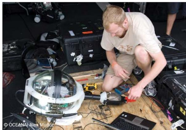
Figura 9. “Dropcams” de National Geographic para filmar en alta definición en profundidades de hasta 12000 m.
