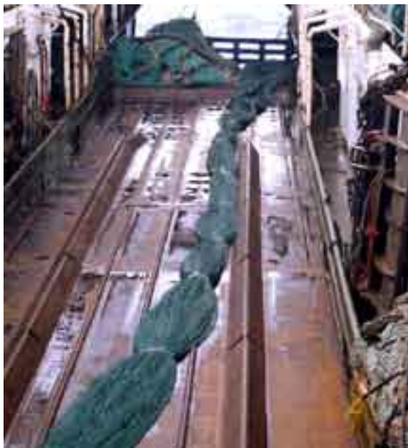
Figura 50. Amarres de una red de arrastre previo al calado para evitar la captura de aves marinas.
